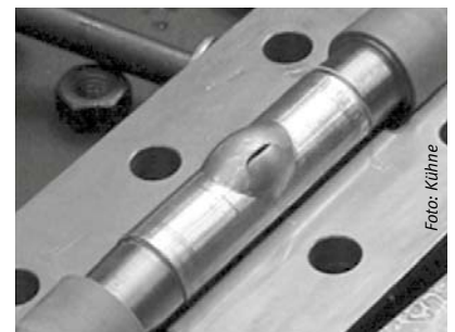
Nicht gleich beim ersten Versuch geklappt: die Studierenden konnten bei der Herstellung eines T-Stückes aus einem Rohrstück viel lernen
